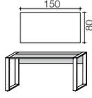
Schreibtisch mit Kufenfuß, geteilte Tischplatte mit integrierter Klappe, erleichtert Zugang zum Kabelmanagement
